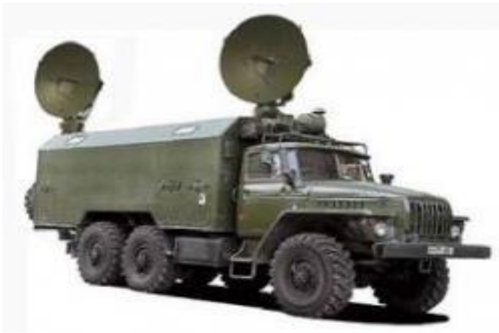
Рисунок 2 – Тропосферная станция Р-423-АМК на транспортной базе
