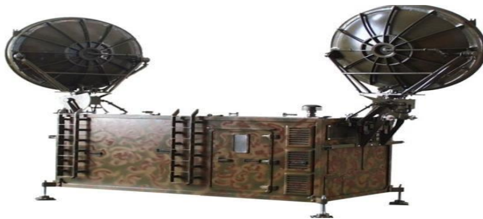
Рисунок 1 – Тропосферная станция Р-423-АМК контейнерного типа
